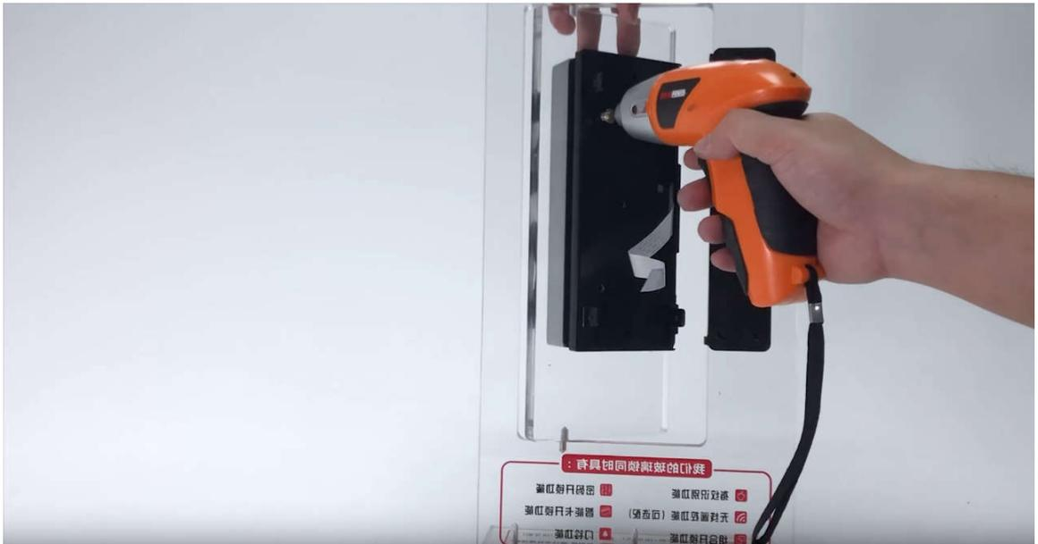
Рисунок 12 - Закрепление внешней части замка
